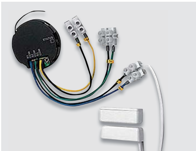
Bild 3: So erfolgen Anschluss und Anordnung des Homematic Funk-Schließkontakt-Interfaces und des Magnetkontakts.
