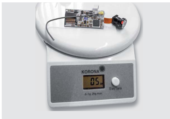
Bild 4: Die gesamte Einheit aus HD-Kamera, Bildverarbeitungssystem samt Speicherslot sowie Videosender des Hubsan H107D+ bringt gerade mal 5 g auf die Waage.
