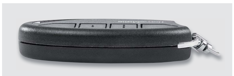
Bild 17: Zum Abschluss erfolgt eine Rundum-Kontrolle auf ein gleichmäßiges Spaltmaß zwischen den Gehäuseshälften.
