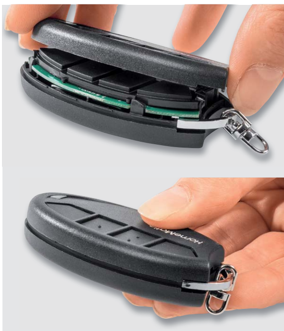
Bild 15: Zum Zusammensetzen der Gehäusenhälften ist zunächst die Gehäuseoberschale von der Batterieseite her seitlich einzusetzen (oben), danach drückt man beide Gehäuseshälften bis zum Einrasten zusammen.
