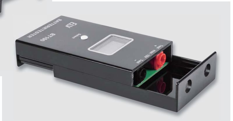
Bild 19: ... werden die Gehäusehälften bis zum Anschlag zusammengeschoben.
