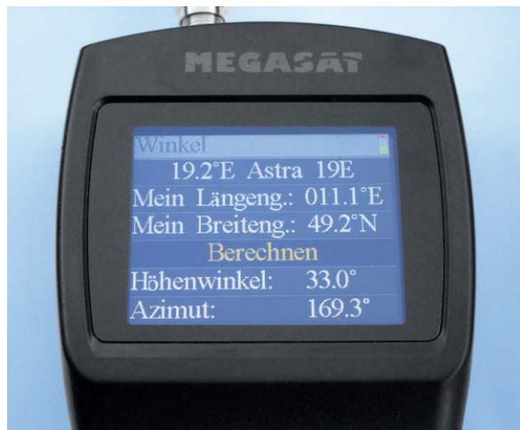
Bild 2: Winkelsberechnung des Satelliten aus Orbitalposition und eigenem Standort
