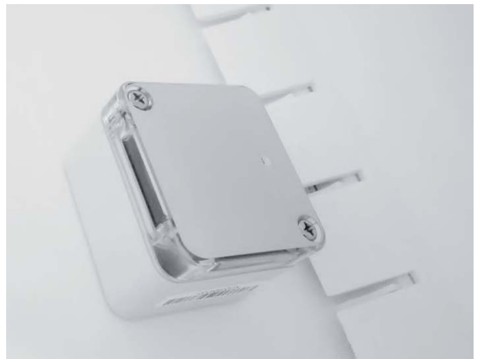
Bild 4: Anbringung des Homematic Funk-Neigungssensors in einem Paketkasten mit Klapptür
