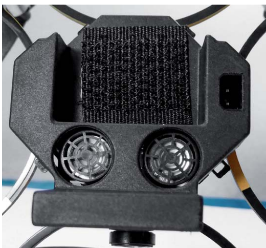
Bild 15: Sensoren, Sensoren, Sensoren – moderne Sensor- und Rechentechnik vermeidet Kollisionen, ermöglicht das Umfliegen von Hindernissen, selbstständiges Starten und Landen.
