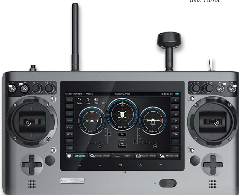
Bild 12: Fernsteuerung mit integriertem Android-Tablet. Bild: Yuneec
