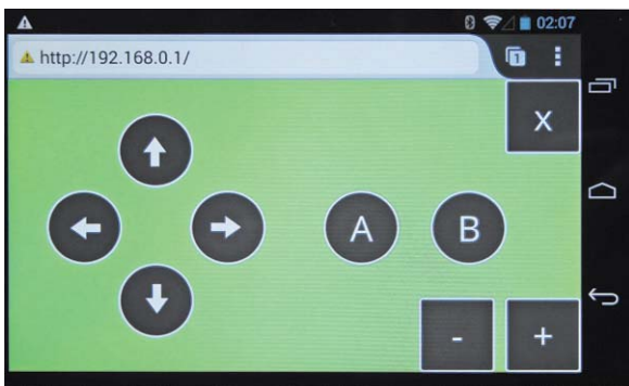
Bild 10: Die WLAN-Verbindung ist hergestellt, der Web-Server des Raspberry Pi quittiert dies, indem die Bildfläche des Handys grün gefärbt erscheint. Mit den Tastenflächen +/- ist die Helligkeit des Displays einstellbar.
