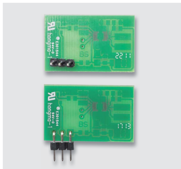
Bild 7: Das DCF-Modul mit gerader (oben) und abgewinkelter Stiftleiste (unten)
