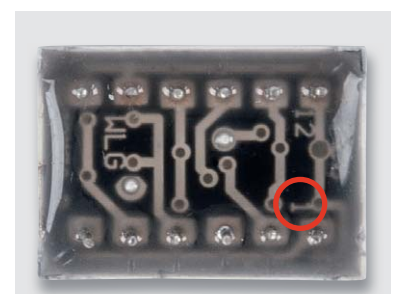
Bild 7: Die Kennzeichnung für Pin 1 der Matrix-Anzeige findet sich auf der vergossenen Platine.
