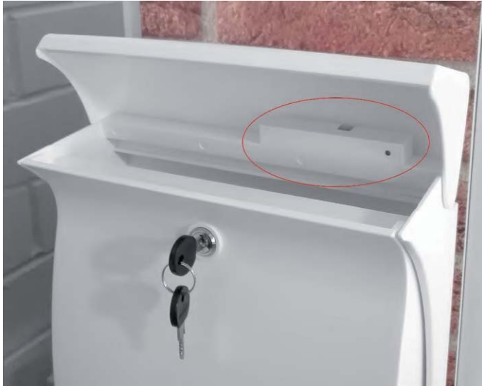
Bild 1: Anbringung des optischen Homematic Funk-Tür-/Fensterkontakts im Briefkasten
