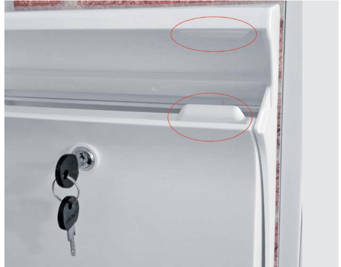
Bild 2: Anbringung eines Reed-Kontakts und des auslösenden Magneten im Briefkasten
