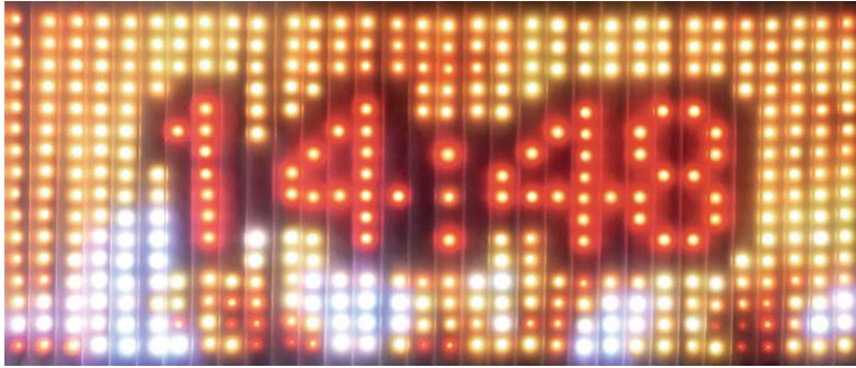
Bild 13: Variable Konfiguration macht es möglich: Das Tetris-Display ist auch als normales Anzeigedisplay einsetzbar. Hier unser Nachbau als Großuhr mit animiertem Hintergrund
