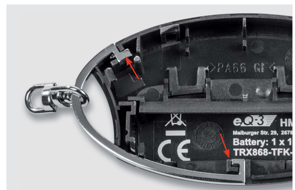
Bild 7: So wird der Metallbügel in die Gehäuseunterschale gelegt.
